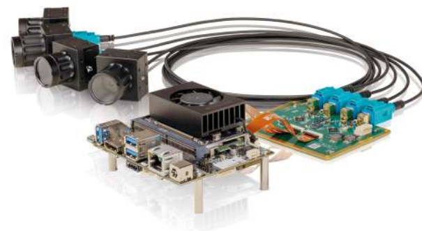
參考設計： 搭載 NVIDIA Jetson Orin NX/Nano SoM 和最多四個 Acuva GMSL2 IP67 攝像頭的載板
