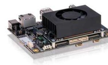
2 通道或 4 通道 MIPI CSI-2 載板配備 NVIDIA® Jetson Orin NX 系統模組
