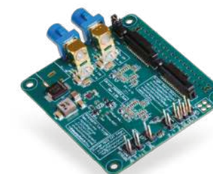
4 通道 GMSL2 和 FPD-Link III 解串器 (即將推出)，適用於搭配 NVIDIA® Orin 的參考設計
