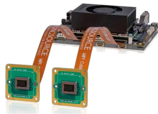
參考設計：配備 NVIDIA Jetson Orin SoM 及 MIPI CSI-2 36S 相機的載板
