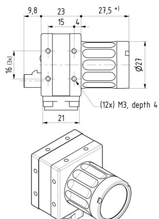
Scale: 1:1 Dimensions: mm Tolerances: DIN ISO 2768-f 275-20-1-01-00-c
